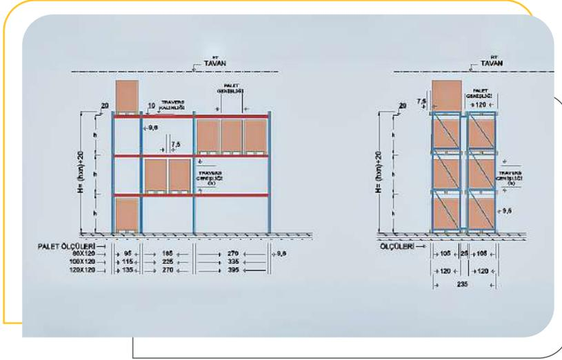
**Paletli Yükleme Rafları**, standart ve farklı ölçülerdeki paletlerin depolandığı en yaygın raf sistemidir. Kullanılacak istif aracının ve depolanacak paletlerin özelliklerine göre dizayn edilir. Ayak derinliği standart paletlere göre 105 cm'dir. Paletler, seri ve emniyetli şekilde yükleme ve boşaltma yapılmaması amacıyla her iki taraftan 7,5 cm traverslerden dışarı atar.
